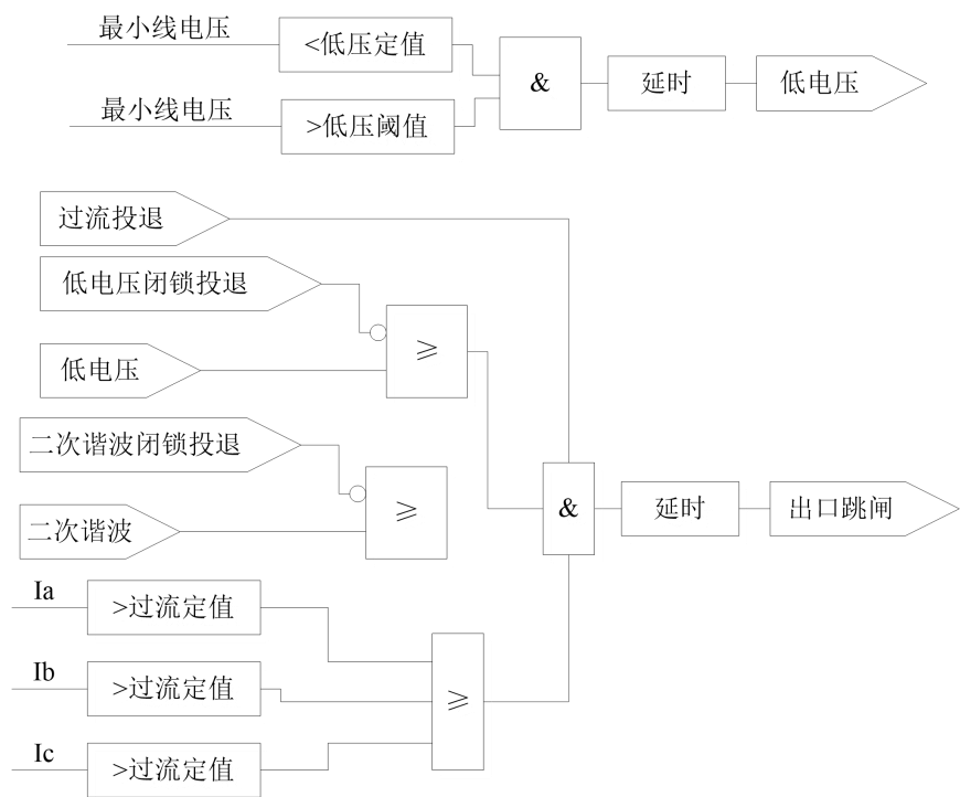
图 1.1 三段式过流保护逻辑
